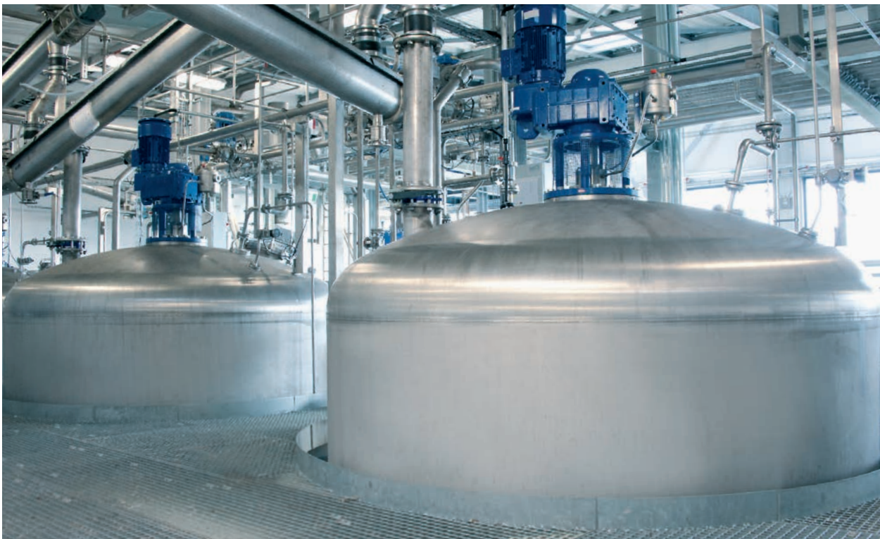
In der Bioraffinerie in Straubing wird Ethanol als Biokraftstoff und für andere industrielle Anwendungen gewonnen. Als Rohstoff dient Stroh.
